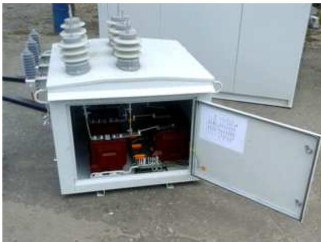
Пункт коммерческого учета электроэнергии **ПКУ** служит для учета, контроля, сбора и передачи информации о расходе электроэнергии. Учет ведется в распределительных сетях, в которых напряжение тока составляет 6-10 кВ, а частота переменного тока 50 Гц.
